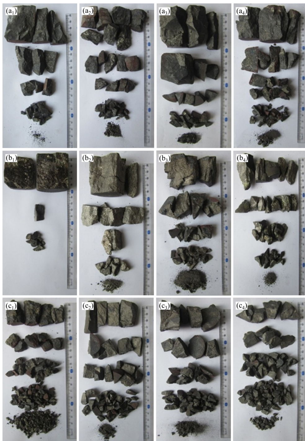
图9 高温处理后含铜矽卡岩的最终破坏特征
