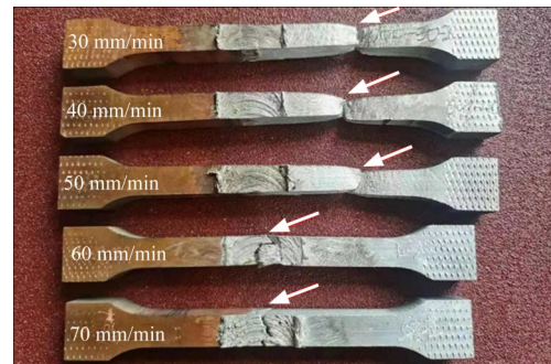
图 12 不同焊接速度条件下接头的拉伸断裂位置
