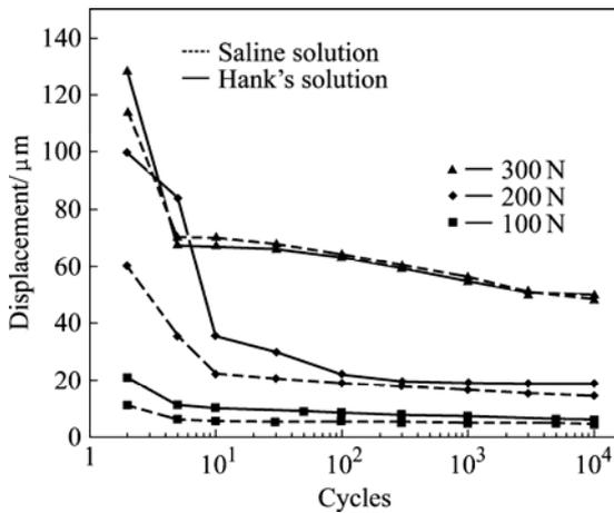
图2 TA2在不同介质中位移随循环次数的变化
