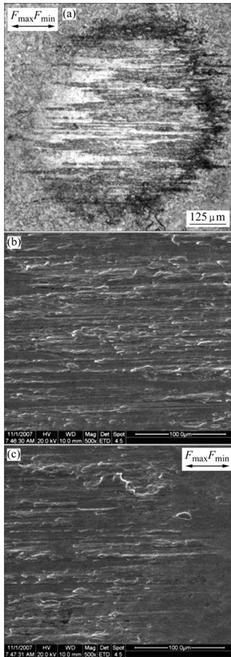
图4 TA2在Hank's溶液中的磨痕形貌
