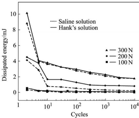
图3 TA2在不同介质中耗散能随循环次数的变化
