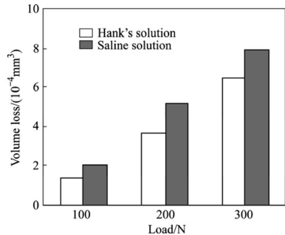
图 6 TA2 在不同介质中的磨损量
