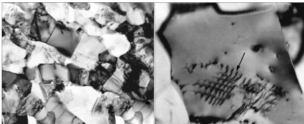
图 6 合金在 850 °C 变形 100% 后的细晶等轴组织
