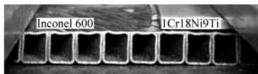
图 1 镍基合金拼焊板与不锈钢搭接装配图
