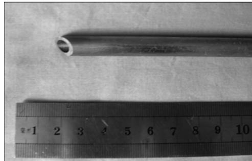
图3 连续定向凝固 Cu-14.3%Al-4%Ni 合金管材照片
