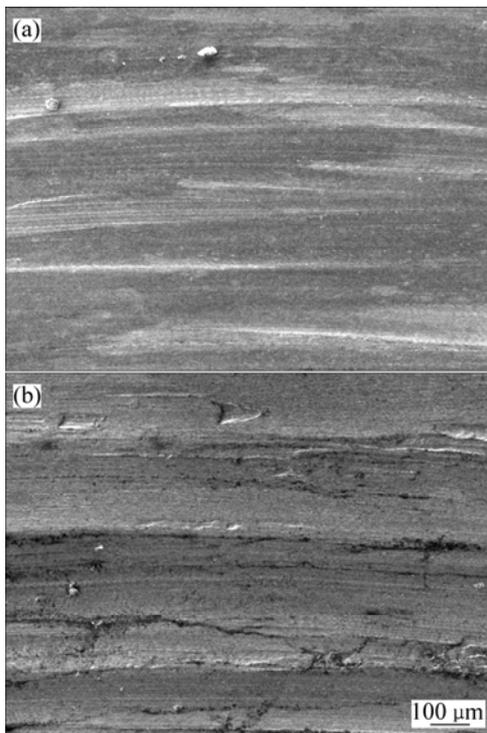
图 5 5% $\text{Si}_p/\text{ZA27}$  复合材料在室温和 60 时的磨面形貌
