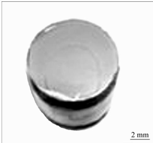
图6 7075Al/SiC<sub>p</sub> 铝基复合材料挤压棒材照片
