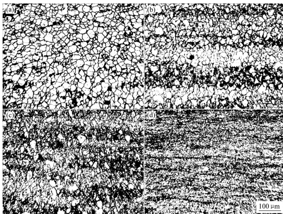
图 4 AZ80 镁合金在 300 °C、 \dot{\varepsilon}=10 \text{ s}^{-1} 和不同变形量下的显微组织
