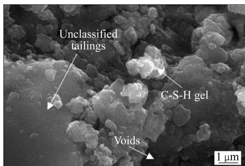
图7 养护3 d的试块中水化产物发育情况
