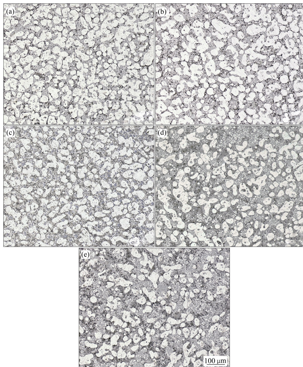
图3 ADC-0.4Mg-0.9Cu在不同温度下保温 15 min 后的半固态组织
