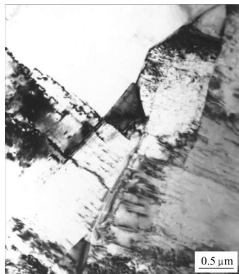
图 5 应变 10%后 AZ91D 镁合金的孪晶形态
