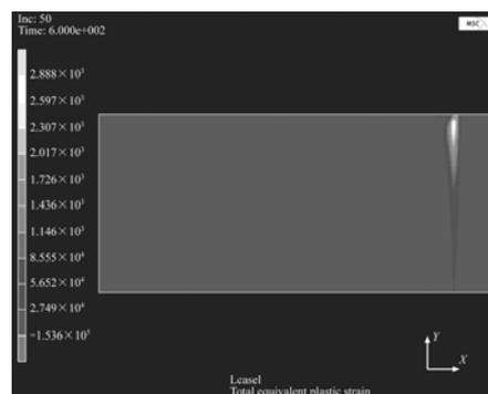
图 10 无过渡层不锈钢基体中明锐界面处出现的塑性约束区
