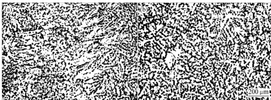
图3 电流30 A时电磁连铸AZ31铸锭组织的显微照片
