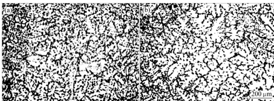
图5 电流50 A时电磁连铸AZ31铸锭组织的显微照片
