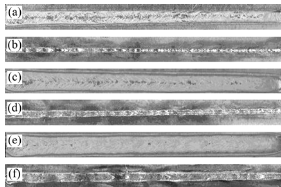
Fig. 1 Optical images of titanium laser welds: (a) Top side, P=6 kW, v=2.0 m/min; (b) Back side, P=6 kW, v=2.0 m/min; (c) Top side, P=6 kW, v=1.6 m/min; (d) Back side, P=6 kW, v=1.6 m/min; (e) Top side, P=6 kW, v=1.4 m/min; (f) Back side, P=6 kW, v=1.4 m/min
