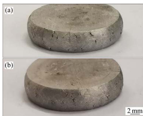
图6 等轴热压的样品照片
