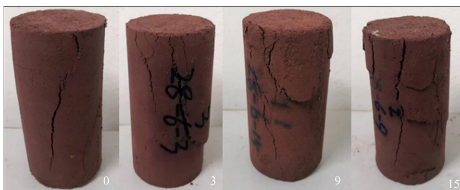
图 3 养护 28 d 固结体单轴压缩破坏图
