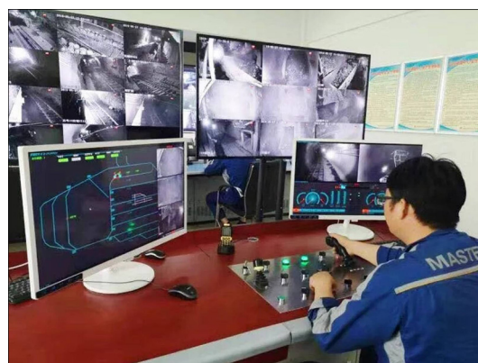
图 8 罗河矿远程操控系统 [41]
