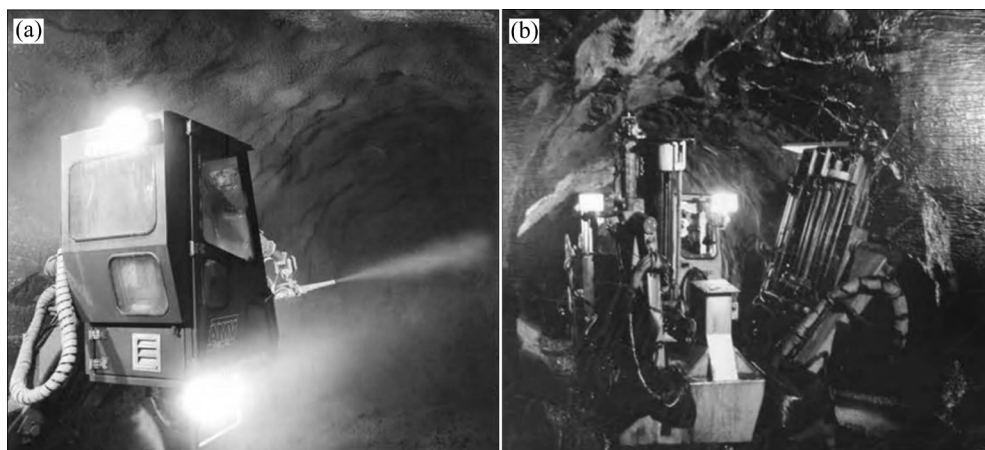
图 2 遥控砼喷射与加固技术 [18]
