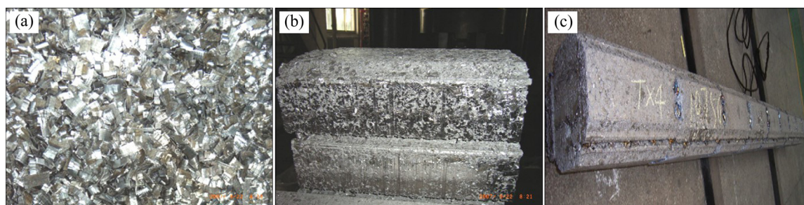
图 1 钛材切削残料的利用
