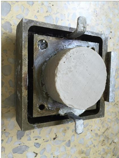
图 1 深海模拟土标准圆柱体试样
