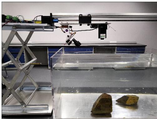
图6 三维重建模拟平台
