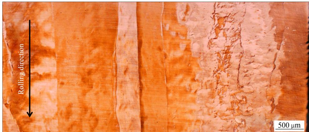
图9 CG  $\text{Cu}_{70.8}\text{Al}_{18.6}\text{Mn}_{10.6}$  SMA 高温轧制后试样的金相组织
