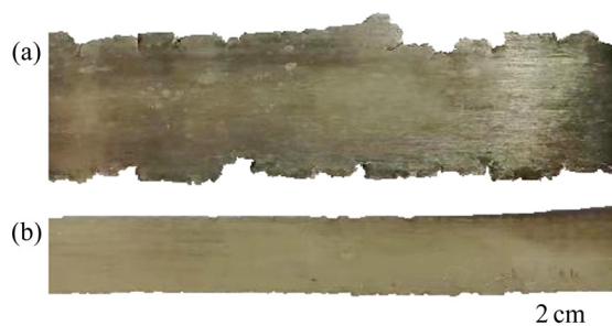
图 11 变形量 94%时经过常规铸造和 HCCM 立式连铸制备的铝白铜宏观形貌对比
