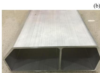
图 12 模具优化后型材横截面上流速分布和挤压型材质量
