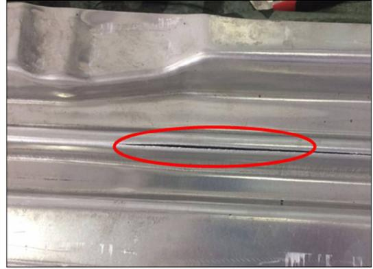
图7 成形件拉裂图
