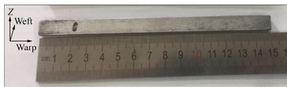
图 4 叠层穿刺结构 C f /Al 复合材料弯曲试样
