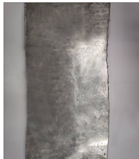
图 4 7075 铝合金铸轧带坯
