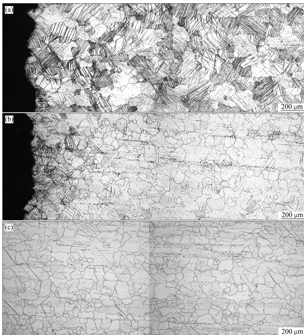
图 7 T6 态 ZM51 镁合金疲劳后纵向光学显微组织
