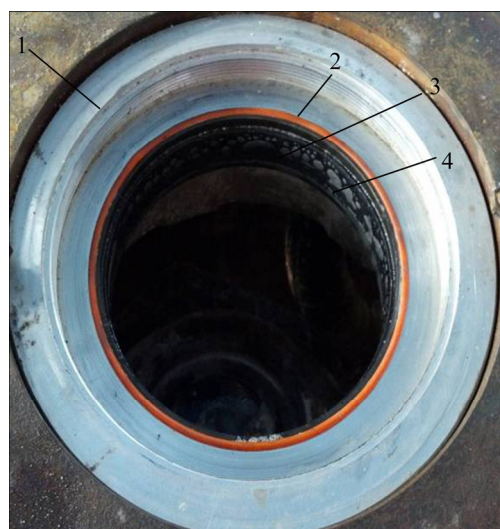
图2 石墨环内表面油气膜照片
