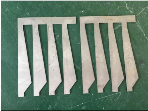
图12 立筋结构芯板实物图
