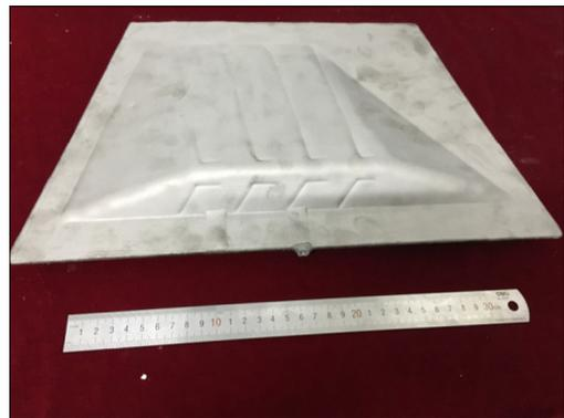
图13 成形后的  $Ti_2AlNb$  合金多层结构Fig. 13 Hollow four-layer structure of  $Ti_2AlNb$  alloy
