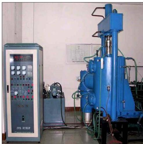
图 1 ZRY55 型真空热压烧结炉
