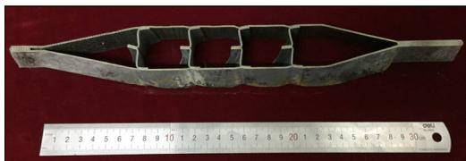
图 15 剖开后的多层结构内部特征
