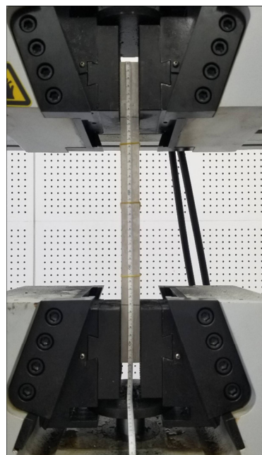
图2 预拉伸实验装置图
