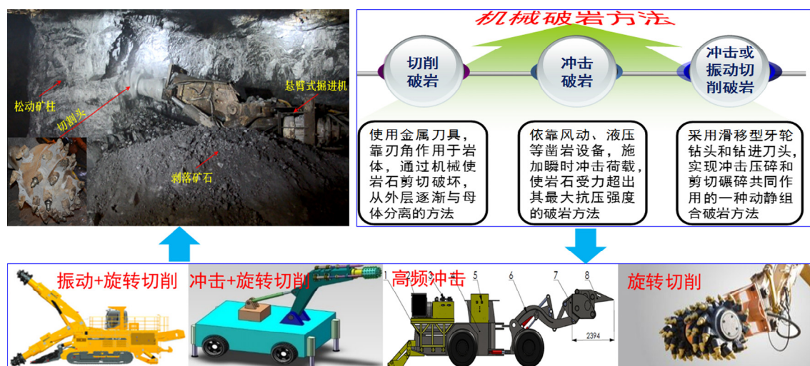
图 21 高应力诱导致裂非爆机械化破岩
