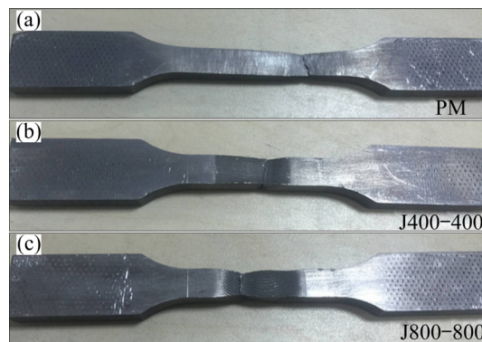
图5 Pb-Sn合金母材和FSW接头拉伸断裂位置
