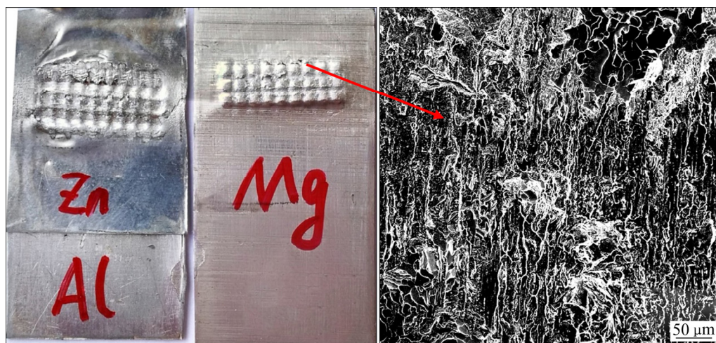
图 11 焊接时间为 0.5 s 的 Mg/Zn/Al 接头撕裂试验的断裂形式及断口形貌
