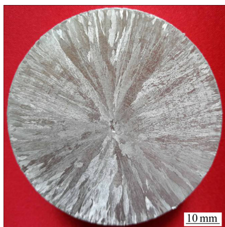
图6 未添加 Al-5Ti-1B 合金时纯铝的晶粒组织
