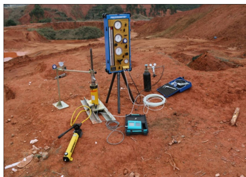
图 4 矿体抗剪强度现场测试图
