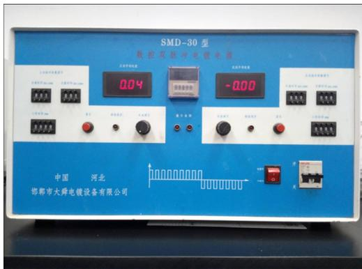
图 1 SMD30 型双脉冲电镀电源
