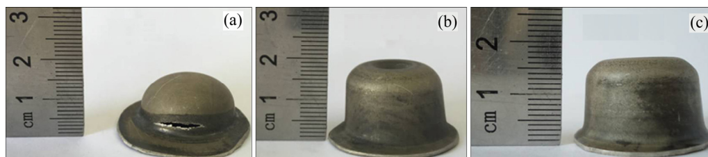
图 7 不同振幅下试验件对比图
