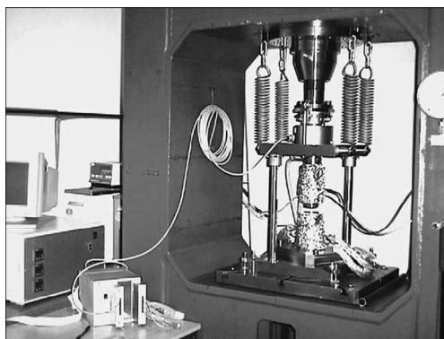
图 4 一维固体传热试验装置 [6]
