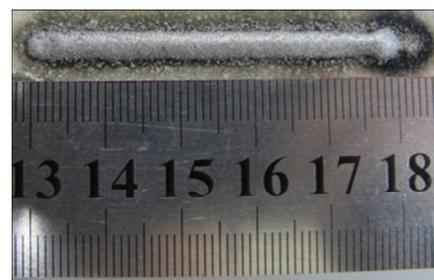
图 7 优化工艺参数下的单层沉积层的外观成型
