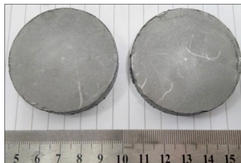
图 1 SPS 烧结制备的 TLM 钛合金试样
