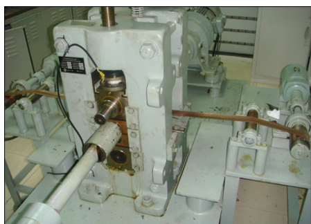
图 10 极薄带制备实验轧机照片
