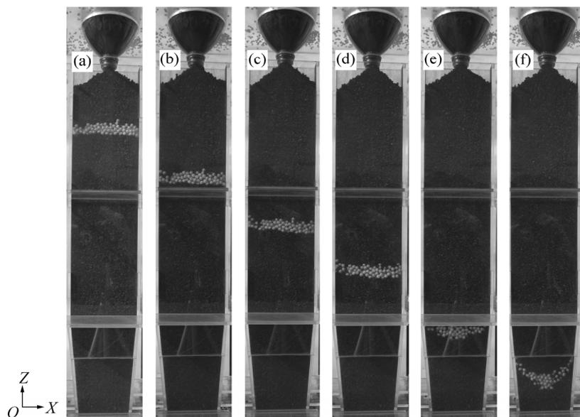
图5 罐式炉冷态模型排料过程的石油焦颗粒料层运动
