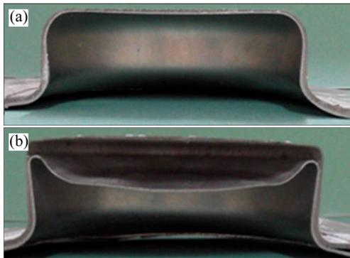
图4 不同温度下成形筒形件的纵剖面
