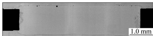
图 2 900 °C 液桥样品纵截面宏观形貌
