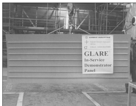
图 9 通过热压罐热压成形的 GLARE 构件 [4]
