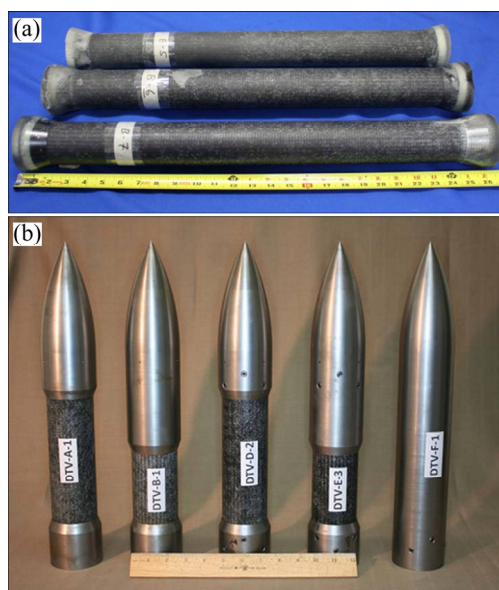
图 3 DE 技术公司制备的钨丝强化树脂基复合材料及与钢复合后的 DTV [33]
