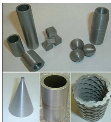
图2 Matsys 公司采用 HIP 制备的反应结构材料 [54]
