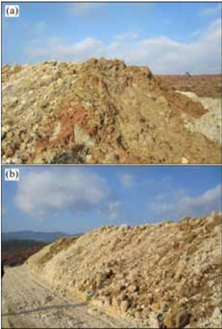
图 2 在渣场堆放的含砷石膏渣 Fig. 2 Arsenic bearing gypsum sludge in slag field: (a) Fresh sludge; (b) Old sludge
