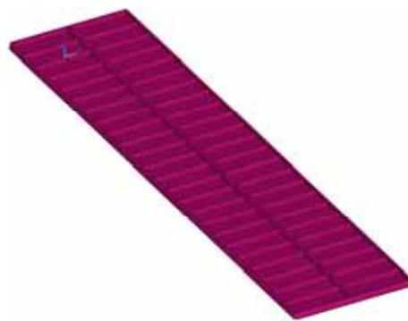
图 1 500 kA 槽电解质与内衬界面换热系数计算网格
