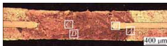
图 4 预置镍层的接头横截面宏观形貌及其分区
